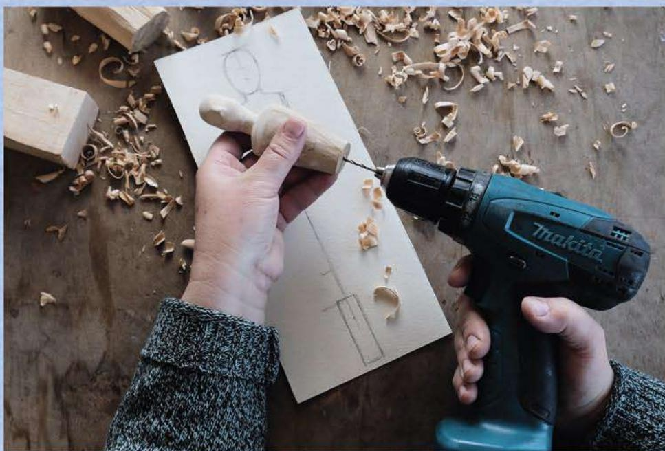
Снизу делаем отверстие под шпинёк.
