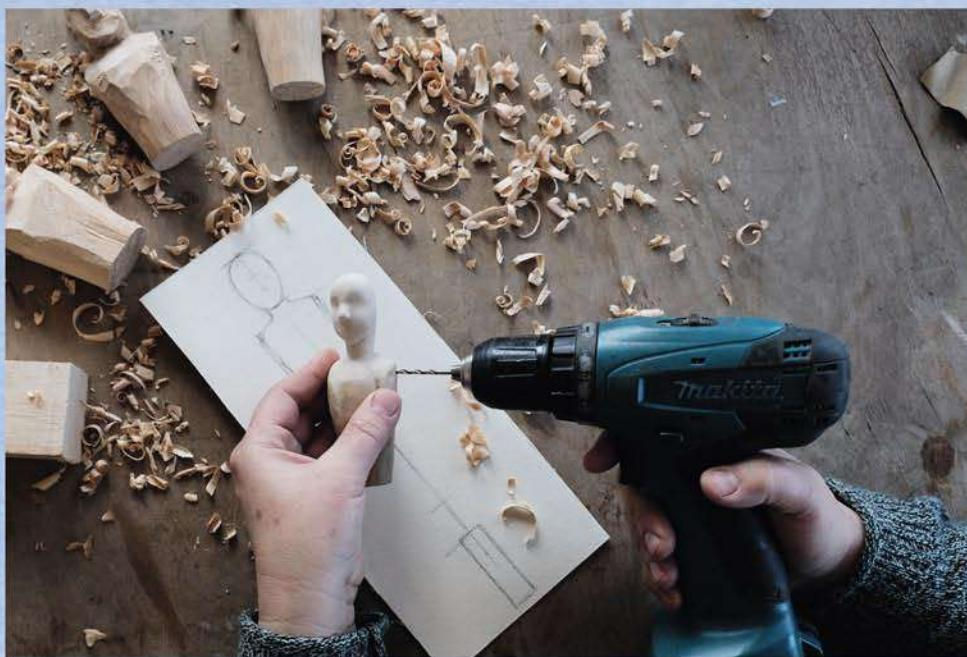
С помощью тонкого сверла делаем сквозное отверстие для проволоки, на которой будут крепиться руки куклы.
