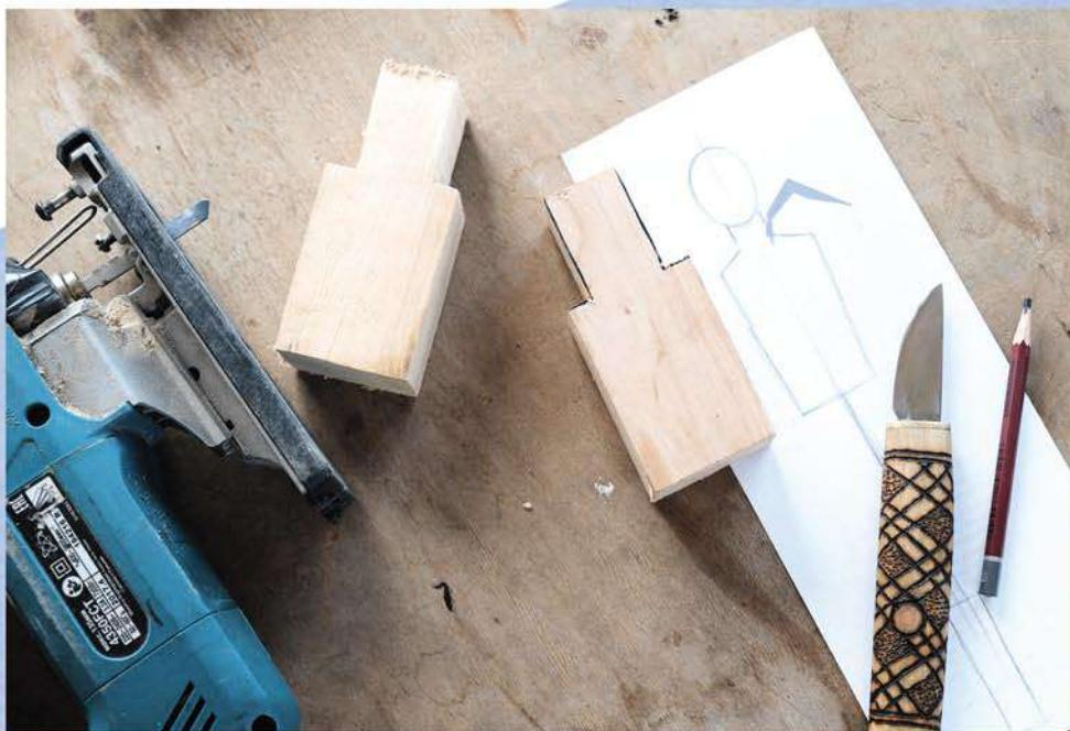
С помощью ножовки или другого инструмента можно задать заготовке под куклу нужную форму. Заготовка делается с учётом того, что голова и шея куклы вместе составляют по длине 5–6 см.
