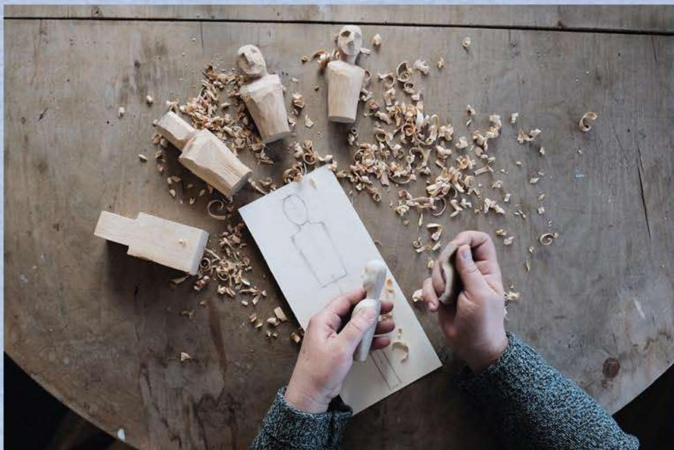
Для придания кукольной заготовке окончательной формы её шлифуют наждачной бумагой. Этот процесс требует большой внимательности, так как при сильном нажиме есть опасность «стереть» лишнее и потерять выразительность формы.
