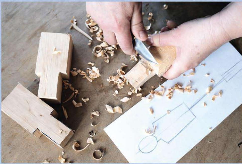
При работе с резцами надо обязательно соблюдать технику безопасности и направлять резец «от себя», контролируя его движение большим пальцем. На фотографии показано правильное расположение рук резчика.
